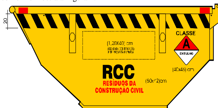
Figura 1: Ilustração da Padronização das caçambas estacionárias da Cidade de Salvador. Fonte: LIMPURB (2009).
