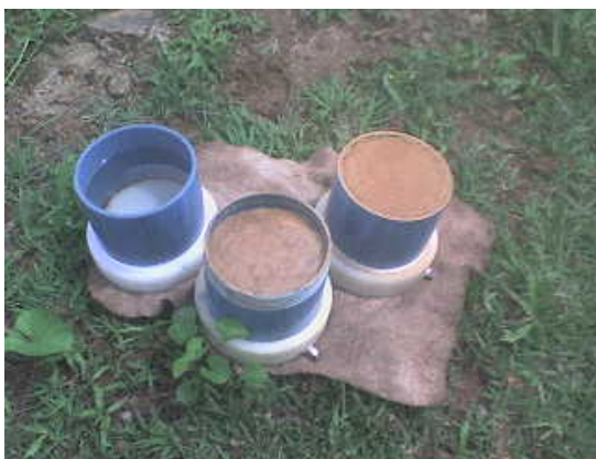
Figura 3. Experimentos: recipientes de PVC com solo compactado e com água expostos ao processo de evaporação
