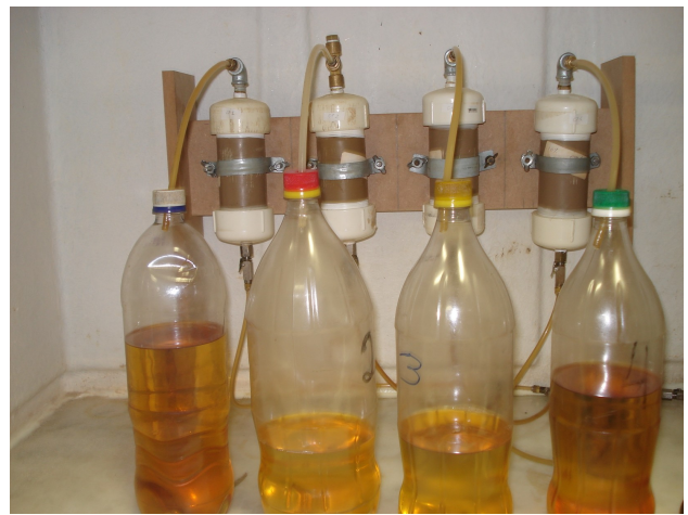
Figura 3. Garrafa plástica na saída da câmara para coletar o volume percolado.
