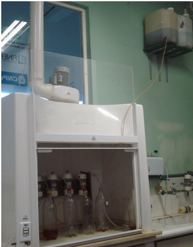
Figura 2. Capela com exaustor para realização dos ensaios com combustível.
